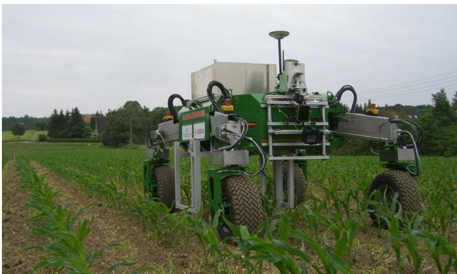
Abbildung 3: BoniRob mit eingebauter Sensorik auf einem Versuchsfeld
