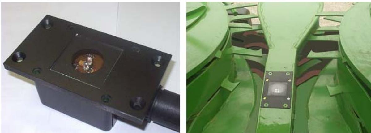
Bild 3: links: optoelektronisches Sensorsystem zur online-Messung des Reifegrades von Mais, rechts: Integration des Sensorsystems im Maisvorsatz des BiG X Feldhäckslers.
